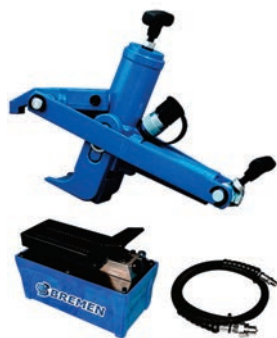
Destalonador de Pneus - Em aço - Operação via pedal - Pressão de entrada 90-145 PSI - Conexão de entrada: 1/4" NPT - Conexão de saída: 3/8" NPT - Extensão da garra 127mm
