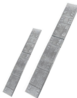
Contrapeso Adesivo Para Roda - Em aço - Utilizado Para balanceamento de rodas - Com fita adesiva dupla face na parte posterior - Peso unitário (tira) de 60g Obs.: Caixa Com 50 peças
