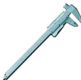
Paquímetro Universal - Em aço inox - Quadrimensional - Graduação de 0,05 mm - Cursor Com guias ressaltadas
