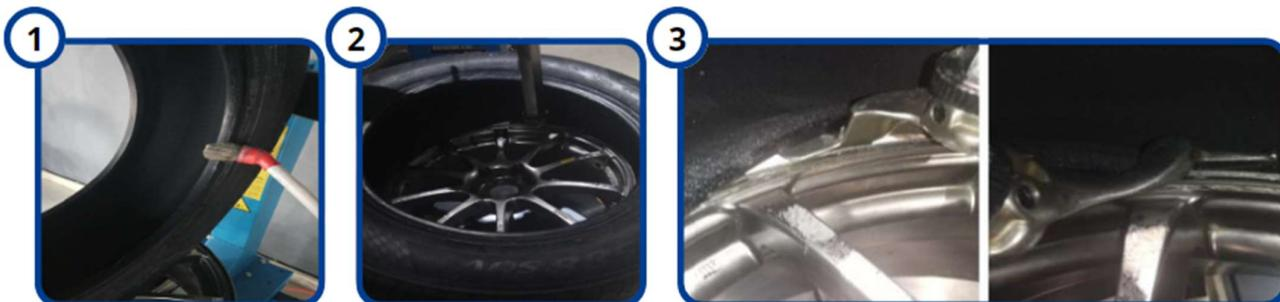
4. Posicione a segunda camada do pneu sobre o bico de pato.
