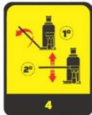
4. Gire a válvula de alívio em sentido anti-horário e faça o bombeamento manual ou acionamento pneumático por cerca de 10 segundos, para eliminar possíveis bolhas de ar do sistema hidráulico.
