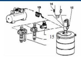
**Fase 2:** Controle a graxa ou pistola de óleo (P) acione a transferência de graxa ou óleo, depois de que a pressão cair na linha. (Dependendo da calibração de alimentação de ar prefixada).
