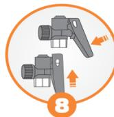
8- O pulverizador funcionará quando o gatilho na alça do bico for pressionado. Para pulverizar continuamente, deslize o gatilho para frente na posição de travamento após pressionar. Para desbloquear, deslize o gatilho para trás.
