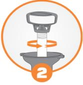
2- Desparafuse a bomba manual de pressurização, rosqueando a manopla no sentido anti-horário.
