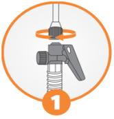
1- Conecte a lana e o bico ao gatilho, aparafusando no sentido horário.
